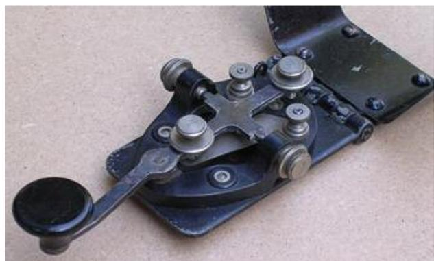
**Fig. 2** – Un diffusissimo tasto americano: il J-37 militare (qui in versione J-45 da gamba). Notare la base a pianta ovoidale, la caratteristica leva piegata e la sommità piatta del pomolo in bachelite; la molla è costituita da una lamina elastica. La leva forma un pezzo solo col proprio perno di rotazione, le cui estremità coniche vanno ad alloggiarsi nei corrispondenti fori ciechi delle viti godronate (dotate di controdado) che fanno da cuscinetto.
