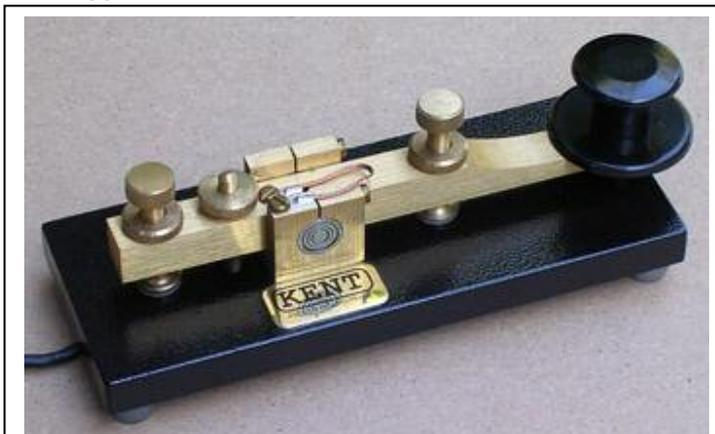
**Fig. 1** – Moderno tasto di fabbricazione inglese (Kent Engineering KT-1). Si notino la pesante base in acciaio verniciata di nero, che si prolunga oltre la verticale del pomolo, la robusta leva a sezione quadrata, l'incernieratura della stessa su cuscinetti a sfere, la trecciola che assicura la continuità elettrica con la leva, il pomolo con gonna di stile navale, le viti di regolazione e i relativi controdadi godronati.
