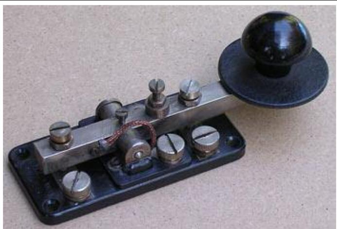
**Fig. 3-** Un tipico (e storico) tasto inglese: il WT 8AMP. Si notano la massiccia leva a sezione quadrata, il pomello in bachelite a funghetto, con la sommità sferica e la gonnola di stile navale, la trecciola che garantisce il contatto elettrico sulla leva, le viti di regolazione e i loro dadi di contrasto manovrabili solo con utensili.
