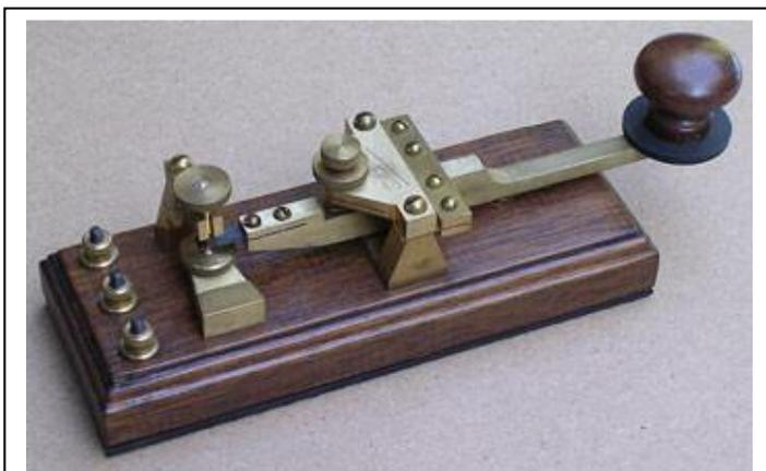
**Fig. 5** – Tasto di tipo svedese, realizzato in piccola tiratura da un'officina italiana. Si notano la base in legno (cava e contenente all'interno una pesante zavorra in lamine di piombo), il complesso molla-cerniera, i contatti elettrici tutti sul retro del tasto; in particolare il contatto normalmente aperto e rovesciato, ossia è in alto; il contatto mobile è montato all'estremità della leva su una lama elastica.
