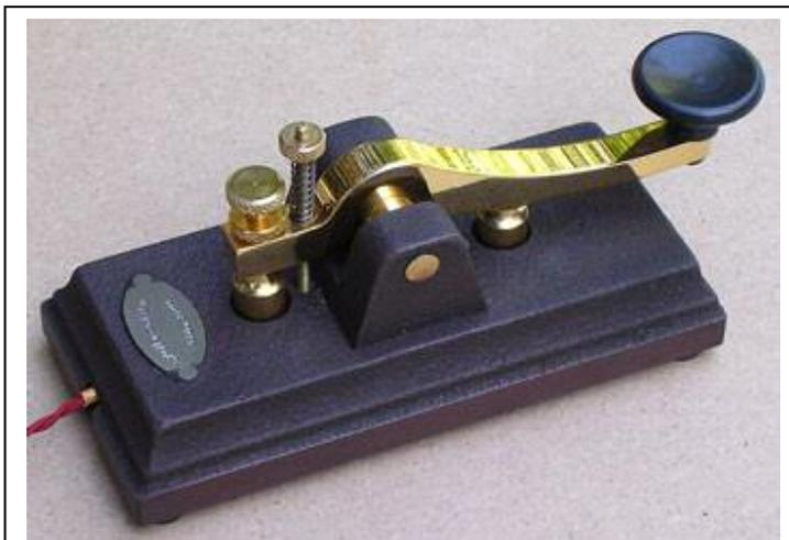
**Fig. 4** – Un tasto *camelback* di fabbricazione attuale, quello di Begali: si nota la pesante base in ghisa, la leva di foggia caratteristica, il pomello di stile tedesco con la sommità incavata. Quest’ultimo è in resina termoplastica di pregio (ABS), realizzato non per iniezione ma per tornitura da barra.
