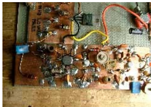
Montaggio “dead bug style” (foto di I0SKK)
