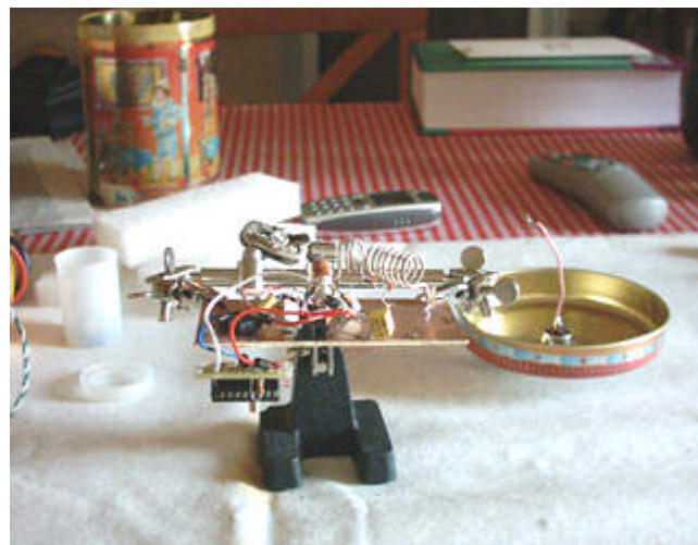
Foto1. Vista frontale del beacon ultimato. Sul lato inferiore del beacon si vede il keyer CW+QRSS. Nel contenitore cilindrico sullo sfondo verrebbe ospitato il beacon.
