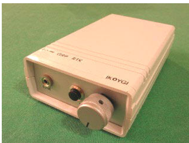
Fig. 4 Vista frontale e posteriore del Rockmite in versione con potenziometro per il volume
