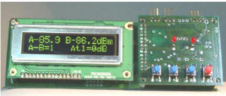
La basetta del display e del circuito pilota del tastierino di comando dello strumento, pronto al montaggio
